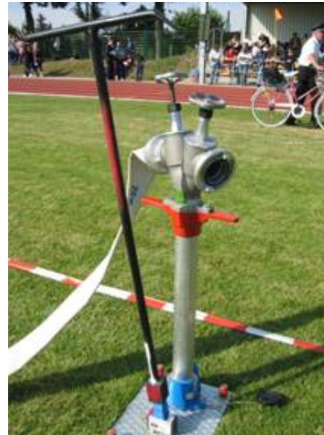
Setzen des Standrohres
